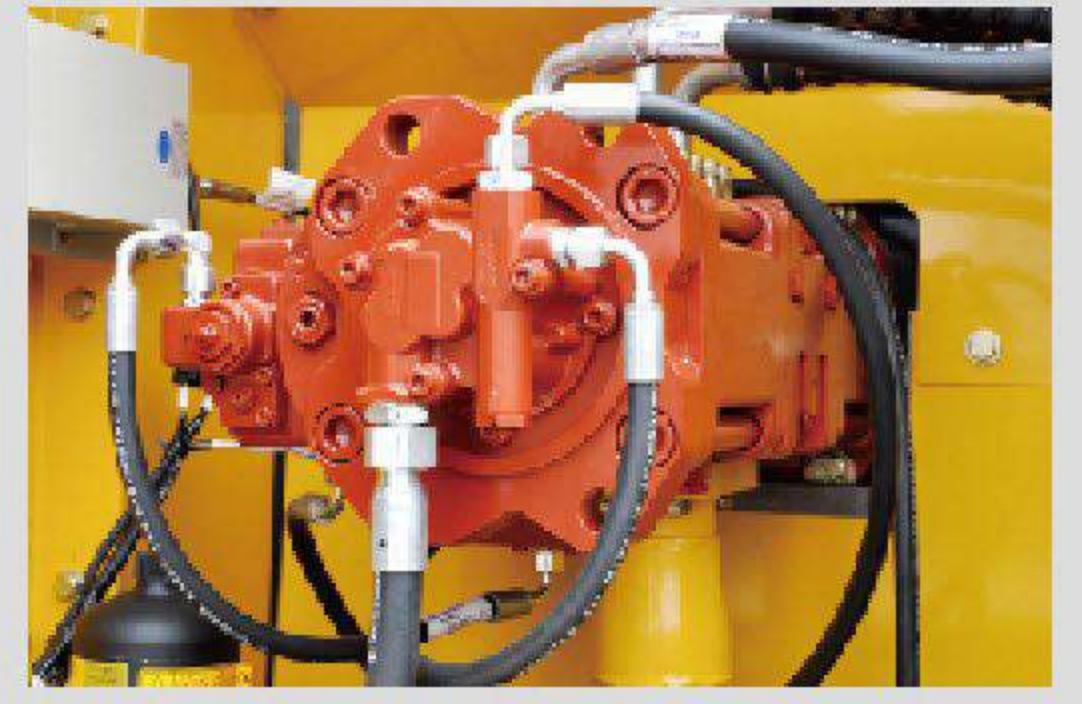
成熟、可靠的负流量、双泵交叉全功率控制液压系统，响应速度更快。
