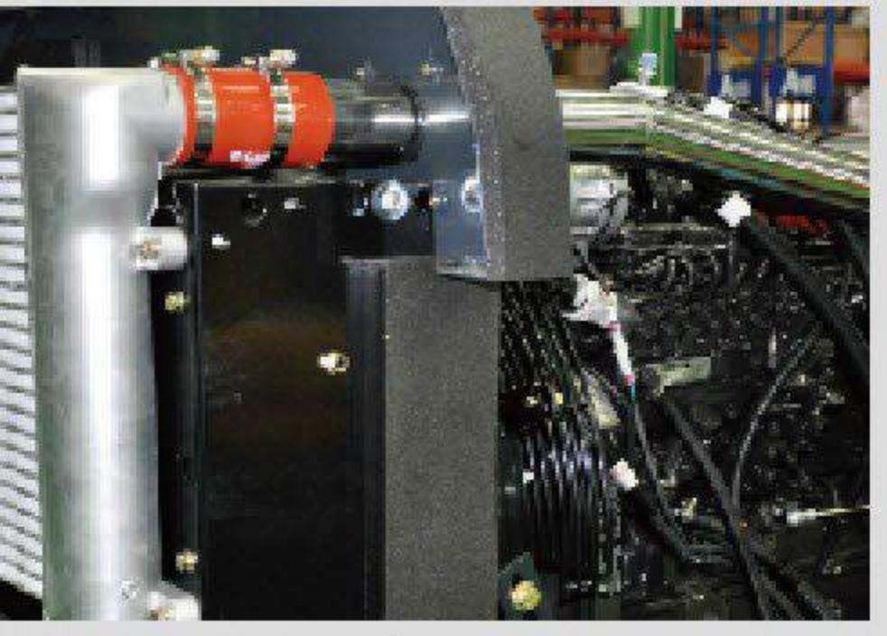
三位一体进气管冷却器，采用不锈钢材料，散热性能更佳。
