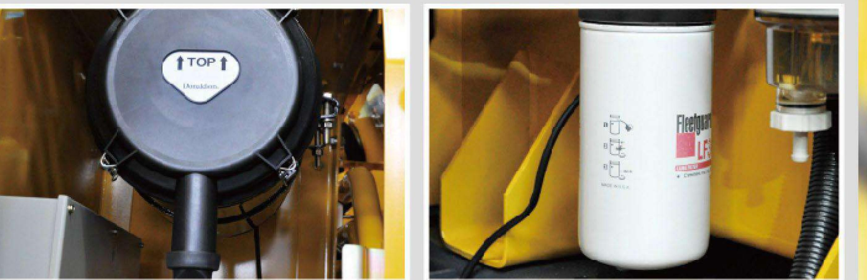
采用插入式世界顶级品牌空气滤清器滤芯，更换容易，维护时间高达500小时
