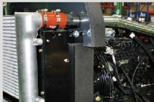
三位一体进气管冷却器，采用不锈钢材料，散热性能更佳。
