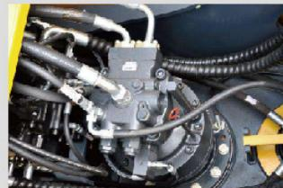
强劲及精确的回转控制，显著提高精细操作性能。
