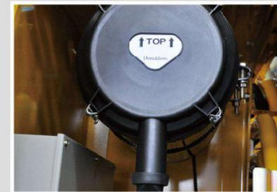
采用插入式世界顶级品牌空气滤清器滤芯，更换容易，维护时间高达500小时
