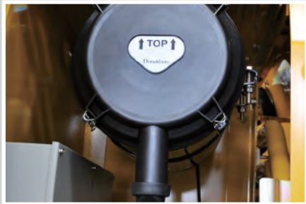
采用插入式世界顶级品牌空气滤清器滤芯，更换容易，维护时间高达500小时
