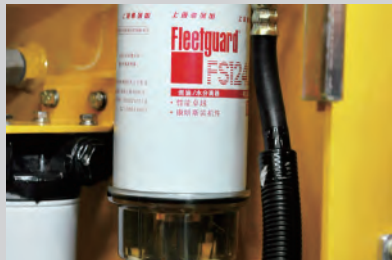
增加一级油水分离器，精度达到10微米。
